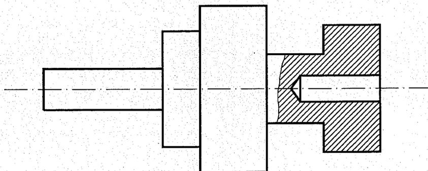
5.- ISOMÉTRICA. Representar en PERSPECTIVA ISOMETRICA, a escala 3:2, la figura correspondiente a las proyecciones. Calcular gráficamente y aplicar en la representación los coeficientes de reducción. Dibujar el perfil correspondiente a la solución hallada.
