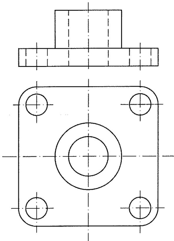
5.- CABALLERA. Representa en PERSPECTIVA CABALLERA, a escala 3:1, la figura dada por sus vistas. El coeficiente de reducción del eje Y es 1/2. La posición de los ejes es la indicada. Dibuja el perfil correspondiente señalado.
