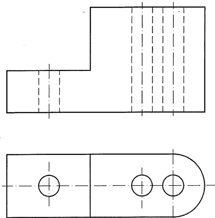
5. ISOMÉTRICO. Representa en PERSPECTIVA ISOMÉTRICA, a escala 3:2, una figura correspondiente a las proyecciones diédricas dadas. Calcula gráficamente y aplica, en la representación, los coeficientes de reducción. Dibuja el perfil señalado de la solución dada.
