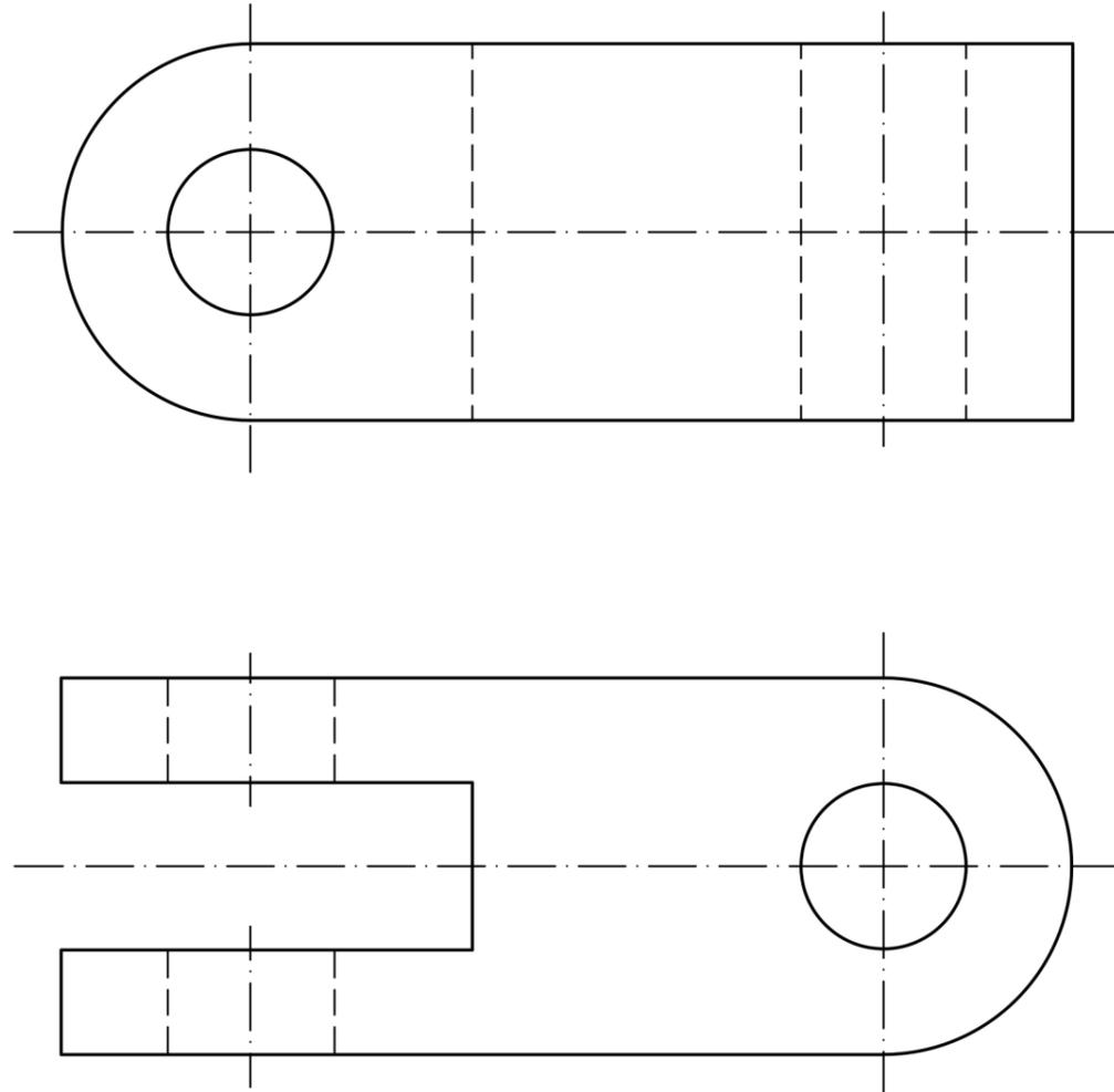
BLOQUE 1. EJERCICIO 4. - VISTAS. Dibuja a mano alzada las vistas (alzado, planta y perfil) de la pieza representada.
